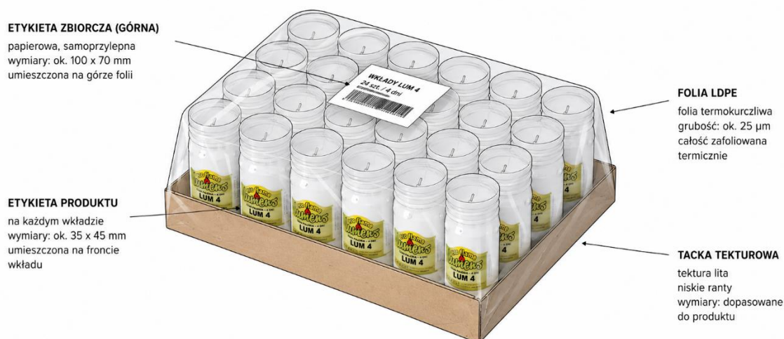
Rysunek 2. Poglądowa konfiguracja opakowania zbiorczego dla wkładów
